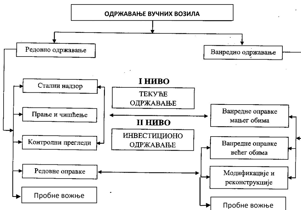
Слика 18. Системска шема одржавања вучних возила
