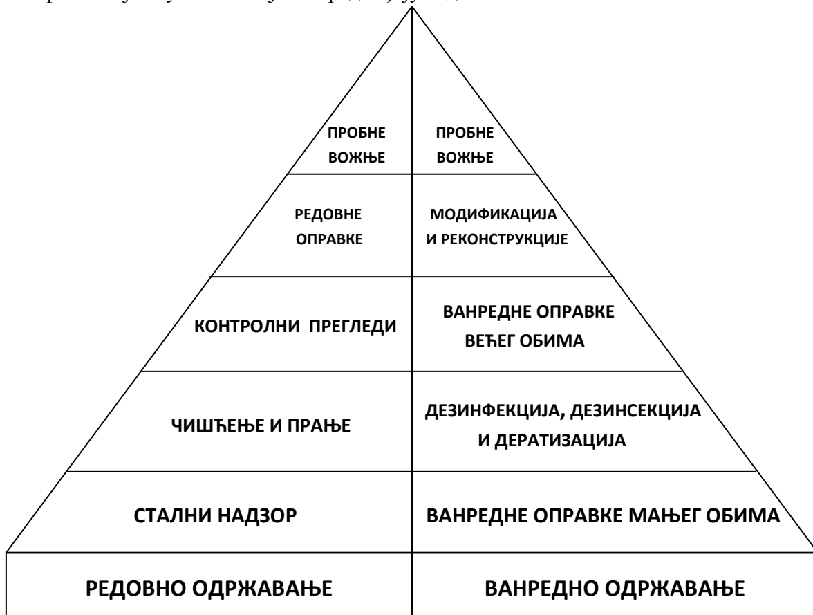
Слика 17. Основни хијерархијски нивои значајности по облику и обиму одржавања вучних возила
