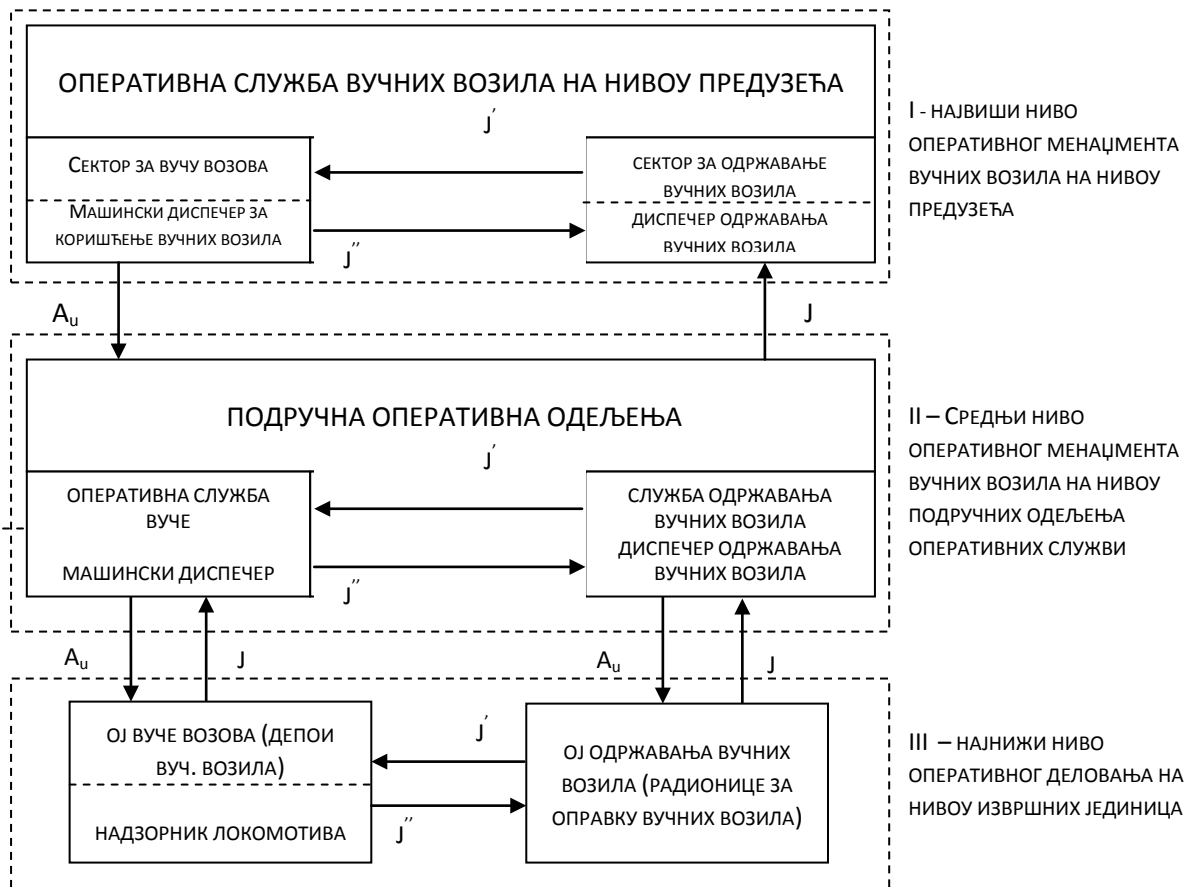
Слика 34. Хијерархијски нивои оперативног менаџмента железничких вучних возила
